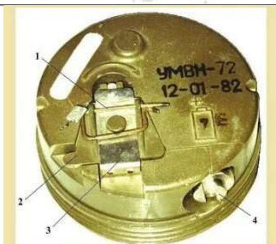
Рис. 19. Взрыватель ТМН-72 (внешний вид): 1 — шпилька; 2 — откидная ручка часового механизма; 3 — предохранительная чека; 4 — пробка гнезда источника тока.
