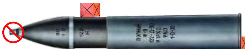
Вид типовой схемы укладки зарядов ВВ (800 г) для 100 и 115-мм унитарных осколочно-фугасных выстрелов
