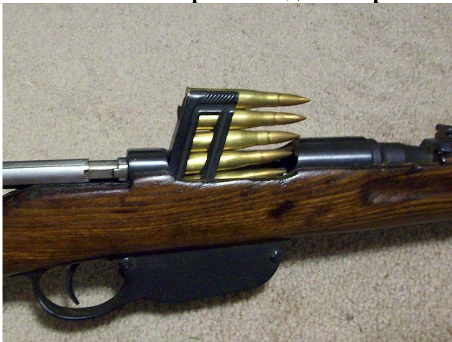
Винтовка Mannlicher M1895, заряжаемая пачкой на 5 патронов. При зарядании пачка остаётся в магазине. Опорожненная пачка выпадает через открытую снизу шахту магазина, что является дополнительным неудобством по сравнению с использованием обоймы, которая
