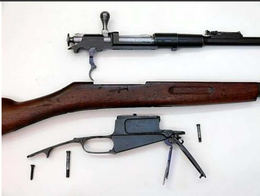
Винтовка Нагана в разобранном виде
