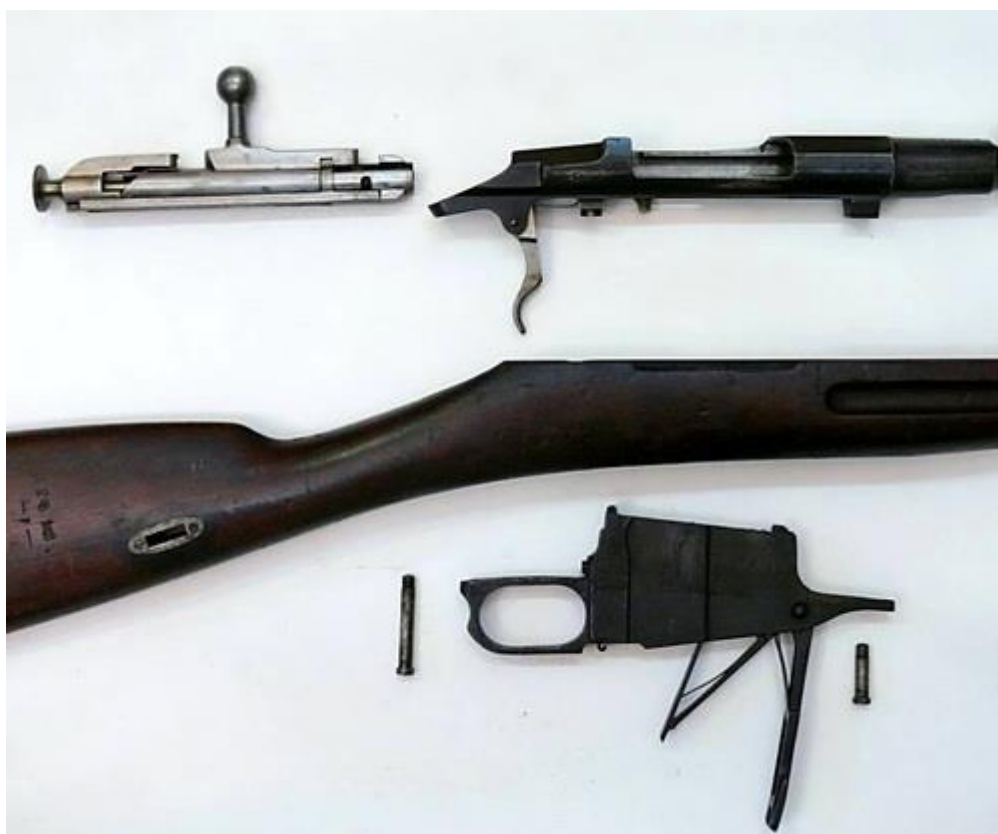
Винтовка Мосина в разобранном виде
